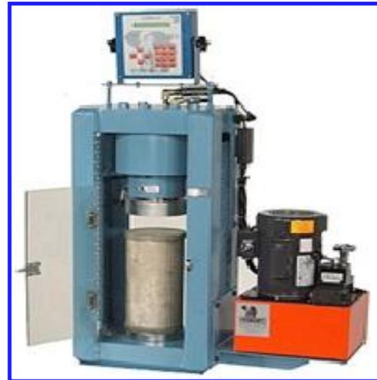
*Ensaio de compressão em corpo-de-prova de concreto*
