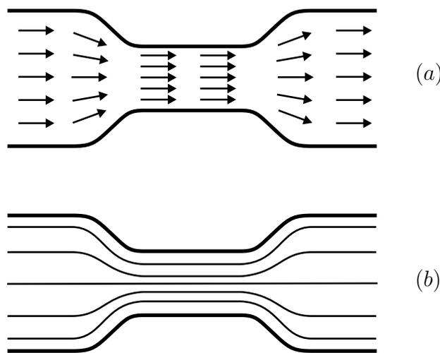
**Figura 3.1:** (a) Campo de velocidades de um fluido escoando dentro de um tubo com um estreitamento; (b) Linhas de escoamento correspondentes ao escoamento representado pelo campo de velocidades mostrado em (a).
