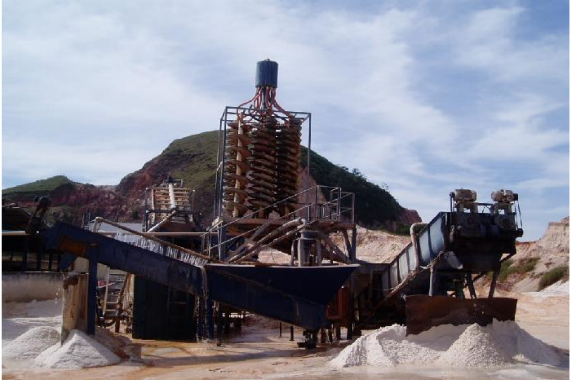
Planta de Lavagem e separação de areia.
