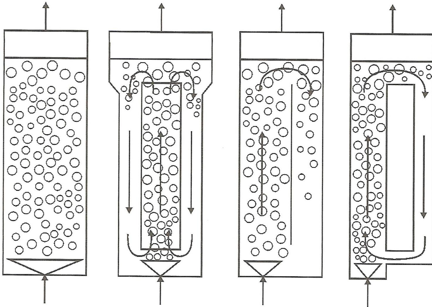
Diferentes concepções de reator “air lift” (esquerda para direita): coluna de bolha normal; “draft tube”; “air lift” com parede de separação; “air lift” com “downcomer” externo.
