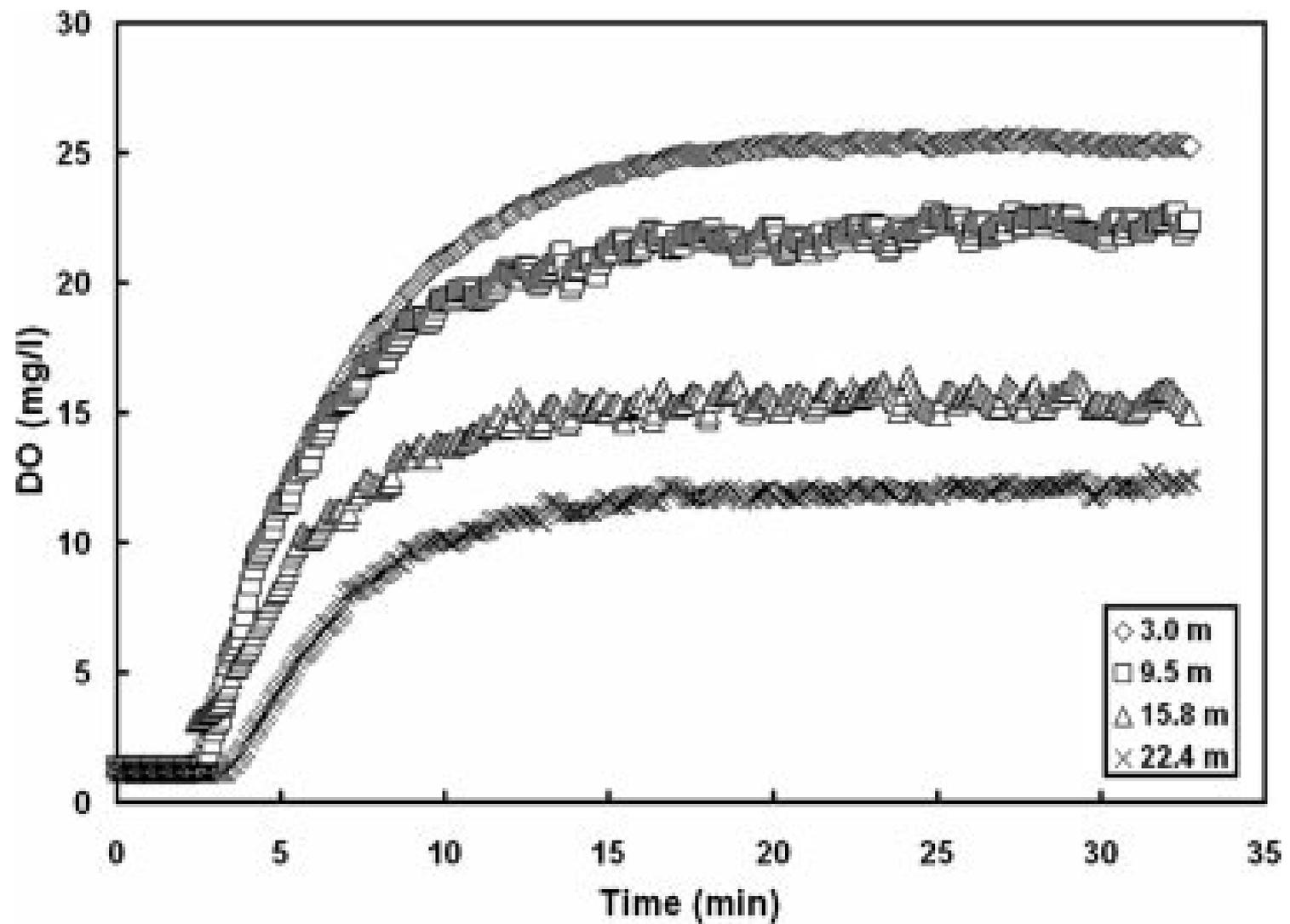
Perfis de concentração de OD medida a várias alturas no reator “air lift” de 23,4 m, empregando uma placa perfurada como aspersor de ar, com  $\mu_g = 0,01$  m/s.
