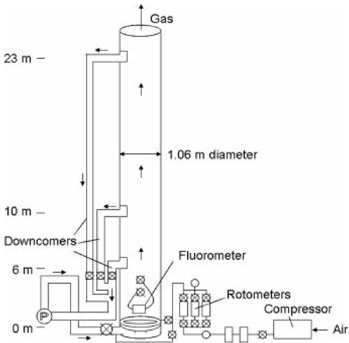
Esquema do reator para ensaios de transferência gasosa.
