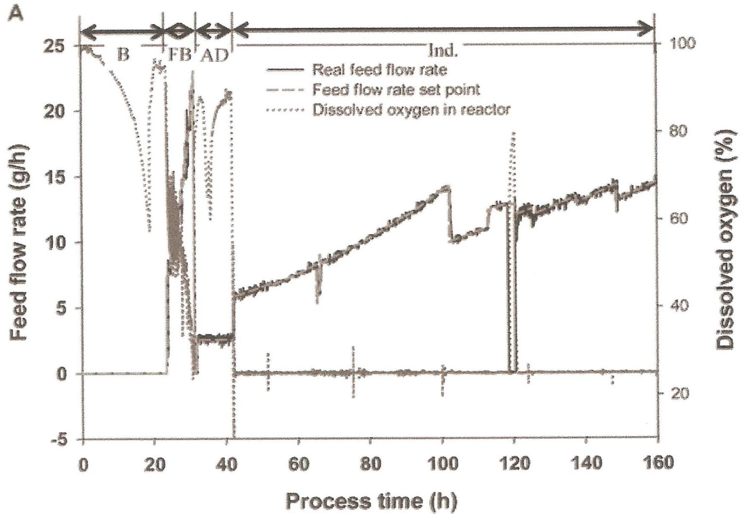
Exemplo do monitoramento do processo *no biorreator* (ensaio 7).
