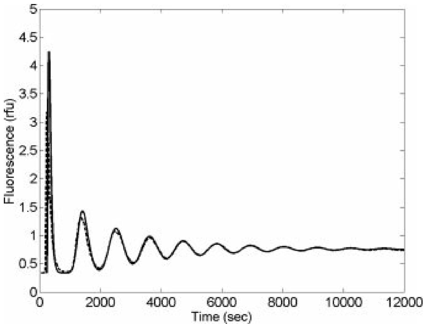
Exemplo de perfil de concentração de corante (pontos) e curva obtida por modelo (linha sólida) numa condição sem aeração, empregando a placa perfurada e altura de 22,4 m.
