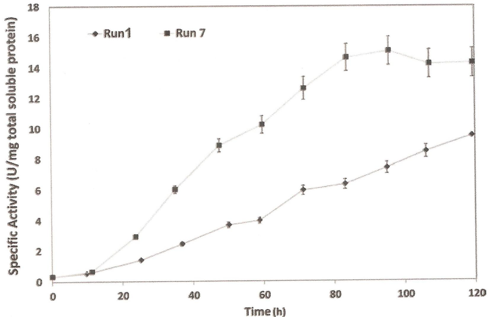
Atividade específica de *HRP* dos ensaios **1** e **7**, com o sistema convencional e de dois compartimentos, respectivamente.
