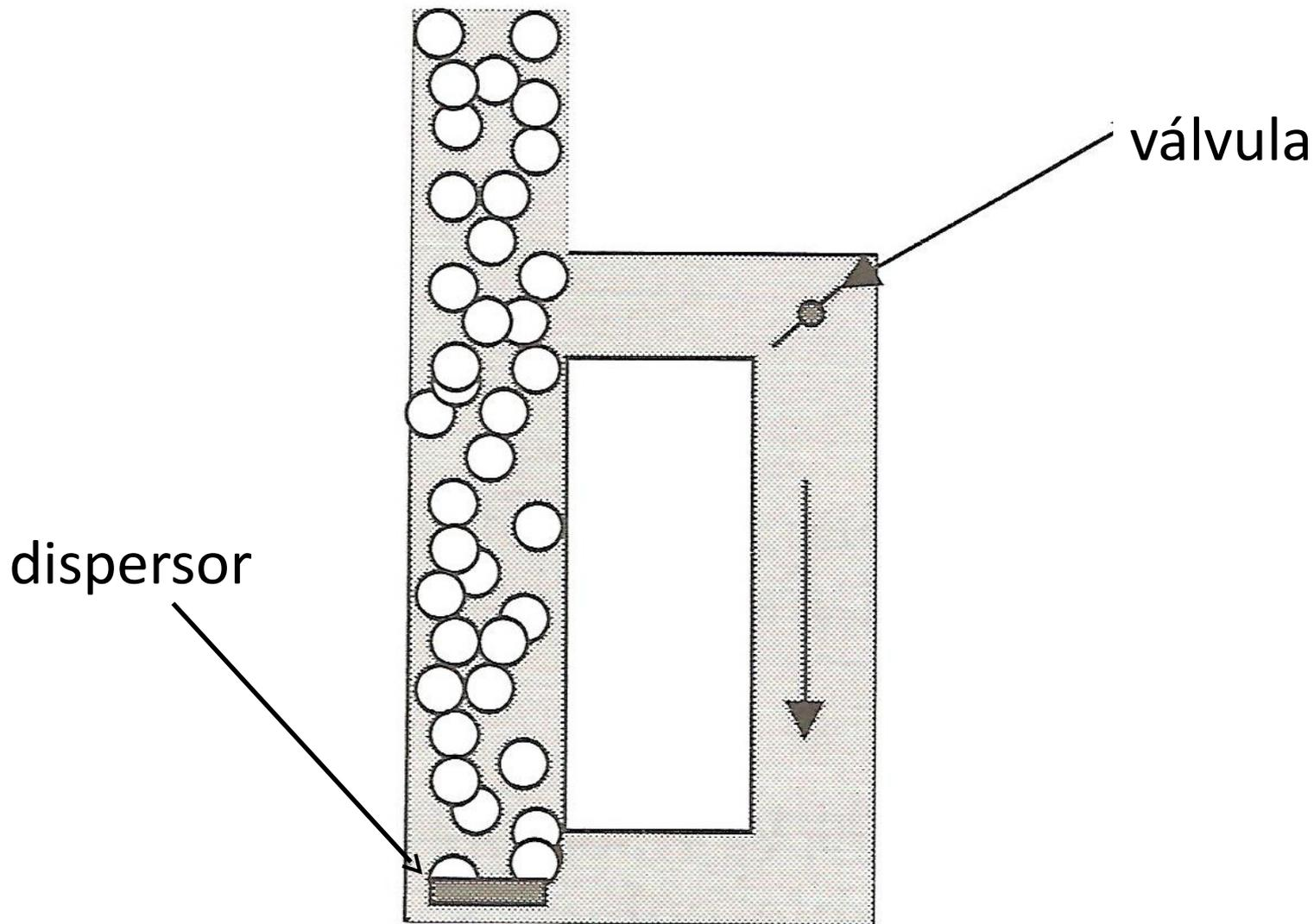
Esquema de um reator “air lift” com retorno externo.
