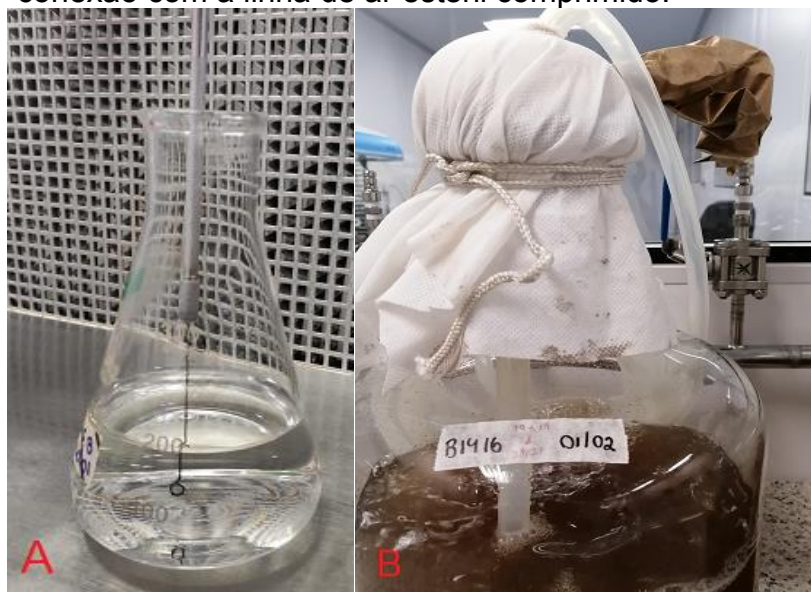
Figura 6 – Inoculação do material biológico no meio líquido em Erlenmeyer (Figura A) e frasco de vidro inoculado aerando (Figura B), a mangueira na figura é a conexão com a linha de ar estéril comprimido.
