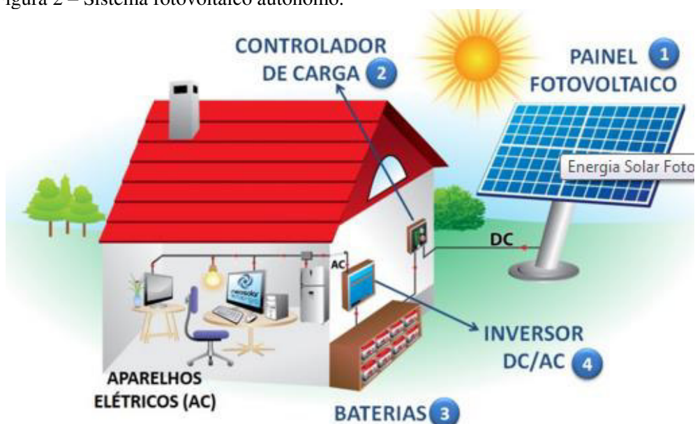
Figura 2 – Sistema fotovoltaico autônomo.
