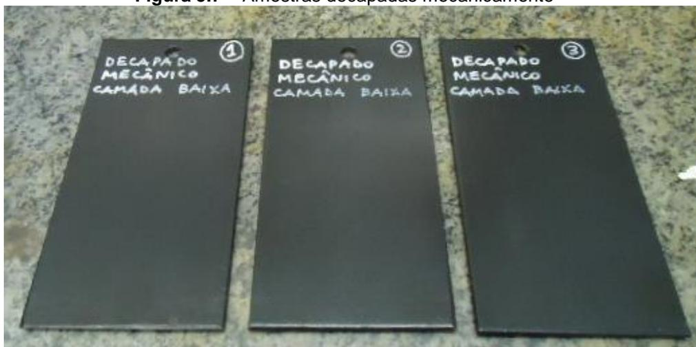
.Após a determinação da camada de tinta, as amostras foram submetidas a testes, com parâmetros definidos pela norma ASTM B117, visando atender os requisitos da norma do cliente A.
