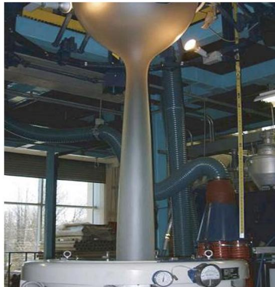
Figura 5 - Extrusora produzindo filme com polietileno de alta densidade (ZATLOUKAL; VLČEK 2006)
