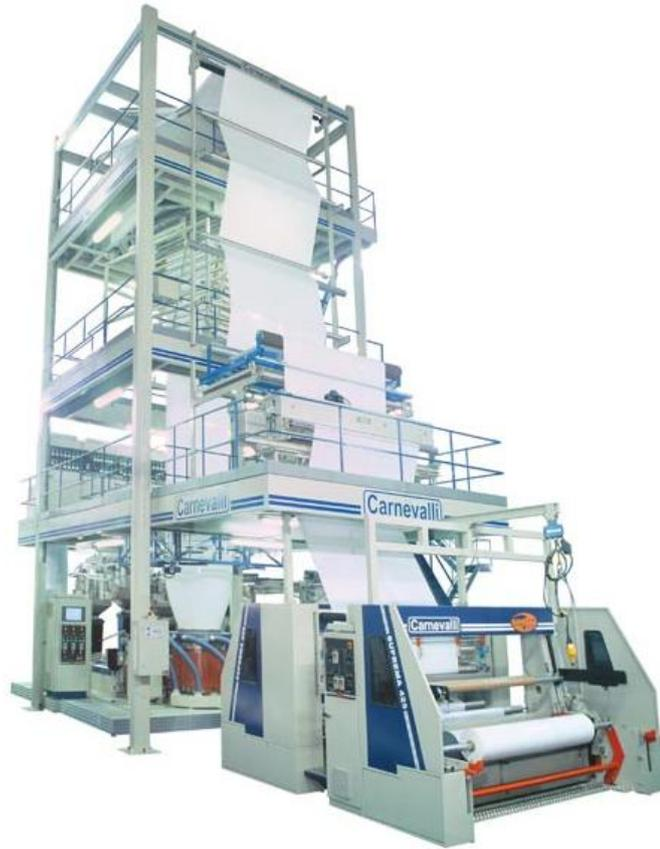
Figura 2 - Exemplo de extrusora de filme tubular soprado. (CARNEVALLI, 2014).
