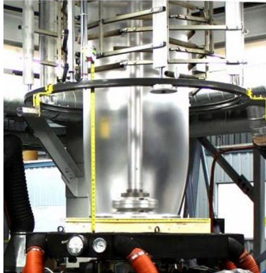
Figura 4 - Extrusora produzindo filme com polietileno de baixa densidade (KOLARIK; ZATLOUKAL, 2013)
