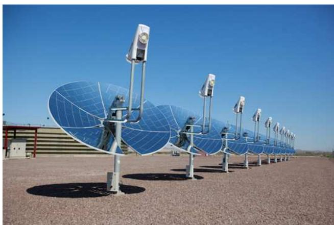
Figura 44 – Concentradores de disco parabólico situados na planta Frito-Lay, Casa Grande.
