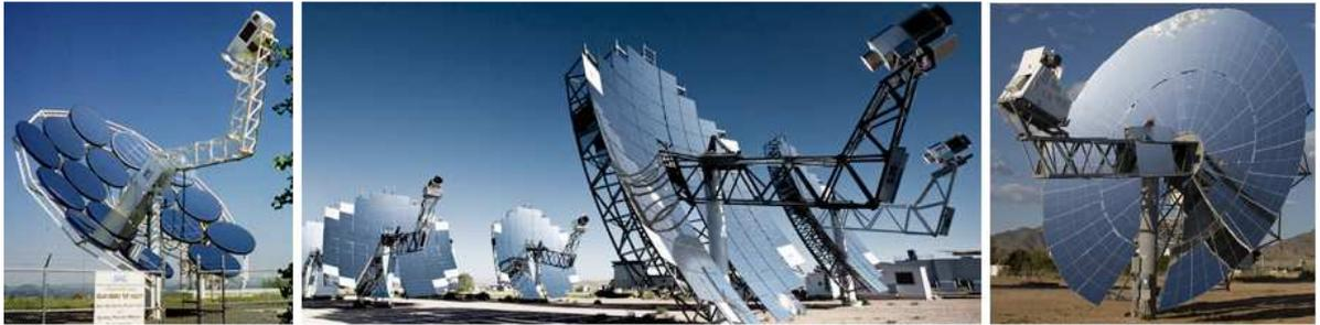
Figura 19 – Fotos de concentradores de discos parabólicos.
