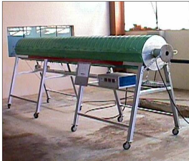
Fig. 3.4 – Forno tubular resistivo com uma região de temperatura homogênea de três metros
