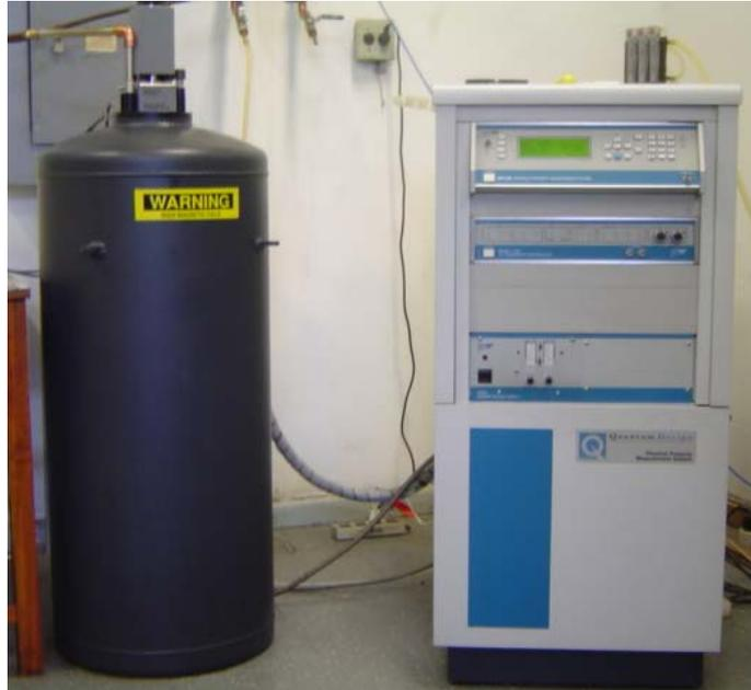
Fig. 3.10 – PPMS, equipamento utilizado para a realização das medidas de magnetização.
