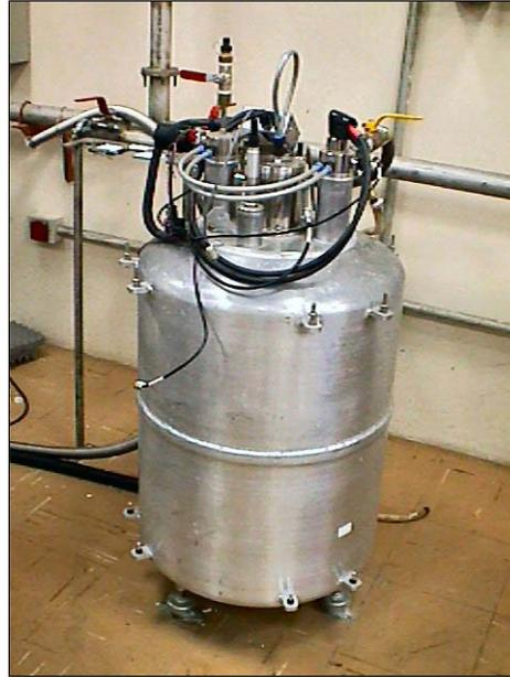
Fig. 3.7 – Criostato de medida com magneto supercondutor a 9 T
