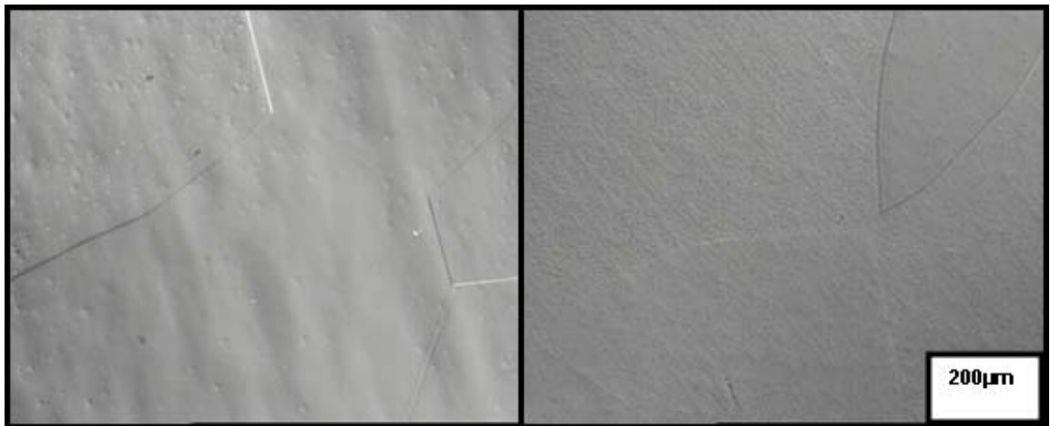
Figura 26. Micrografias ópticas da liga Ti-35,3Nb-7,1Zr-5,1Ta homogeneizada a 1200°C/24h AC.
