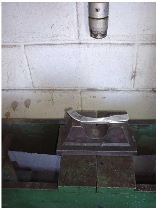
Figura 3.25 – Corpo-de-prova 4 posicionado no dispositivo de ensaio de dobramento lateral.
