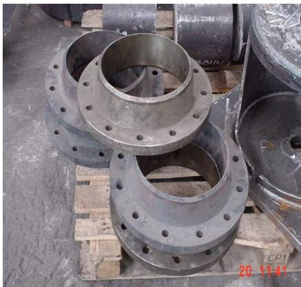
Figura 3.10 - Amostras-2 (Flanges tipo Welding Neck)
