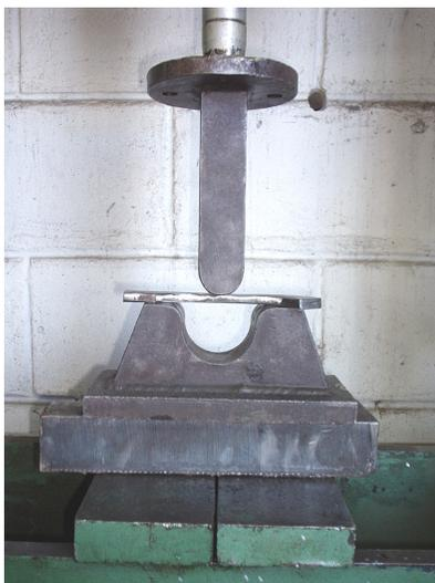
Figura 3.26 – Corpo-de-prova B4.2 (3) iniciando ensaio de dobramento lateral da solda.
