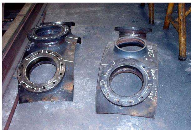
Figura 3.22 - Flanges soldados no pescoço (Processo MAG) - Amostras 2 e 4.
