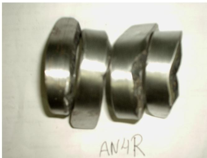
Figura 3.28 - CP'S AN4R .1/2/3/4 após ensaio de dobramento lateral da solda.
