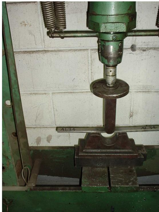
Figura 3.19 - Corpo-de-prova AL3.4 no início do ensaio de dobramento lateral da solda.
