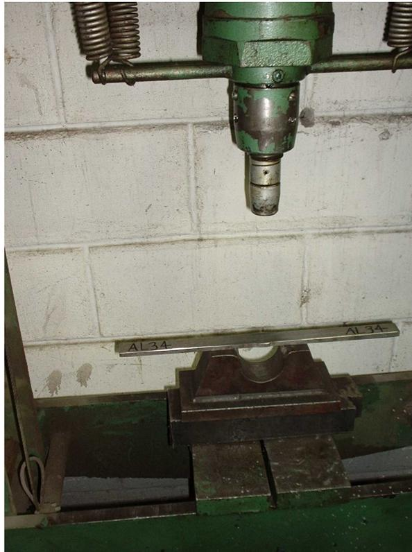
Figura 3.18 - CP Dobramento AL3.4 no dispositivo de ensaio de dobramento lateral da solda.
