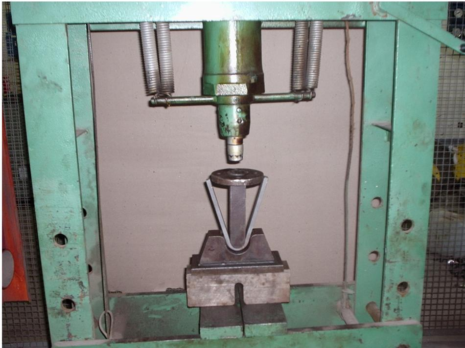
Figura 3.17 - Prensa e dispositivo para ensaios de dobramento.
