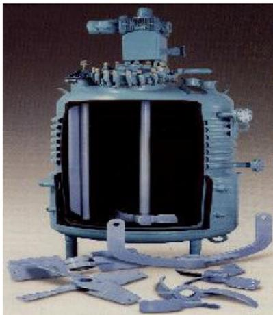
Figura 1.5 - Visão geral de um reator vitrificado.
