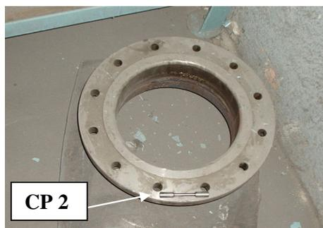
Figura 3.11 - CP-2 reduzido, posicionado em amostra 2 (Flange forjado).
