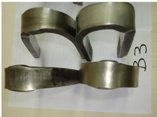
Figura 4.47 - Característica da superfície, após ensaio de dobramento lateral, em amostras B3, sem a presença de trincas.
