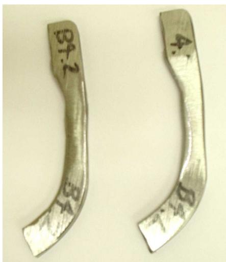
Figura 4.74 – Amostras preparadas para ensaio de dobramento lateral da solda.
