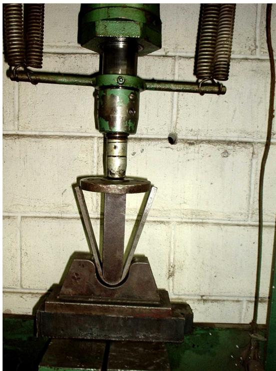
Figura 3.20 – Corpo-de-prova AL3.4 ao término do ensaio de dobramento lateral da solda.
