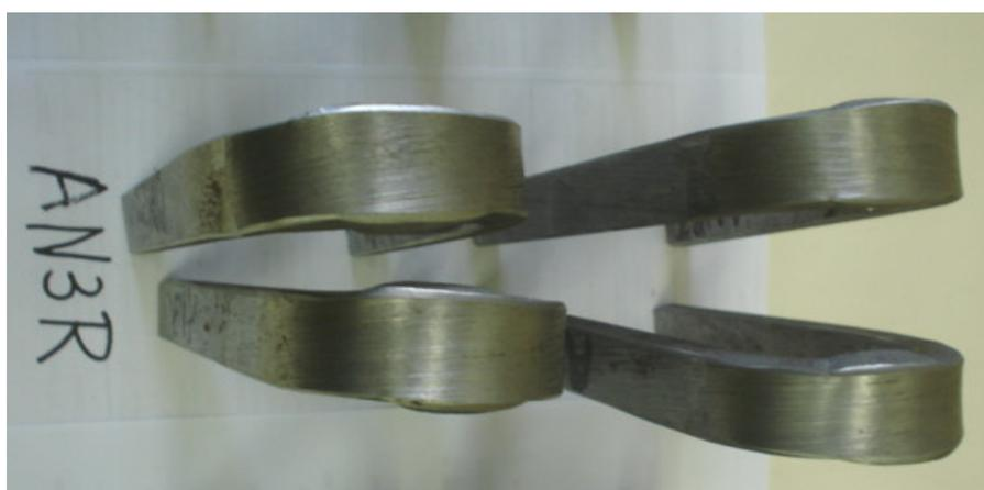
Figura 4.49 – Característica das superfícies, amostras AN3R após ensaio de dobramento.
