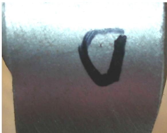
Figura 4.46 - Característica da superfície, após ensaio de dobramento lateral, em amostra AL3.4, apresentando detalhe da trinca de aproximadamente 1,0 mm.
