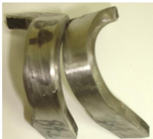
Figura 4.75 – Características superficiais após ensaio de dobramento lateral da solda para os CP'S B4.2 (3) e B4.2(4).
