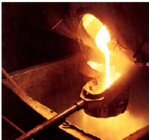
Figura 1.1 - Fusão e fabricação da frita de vidro.
