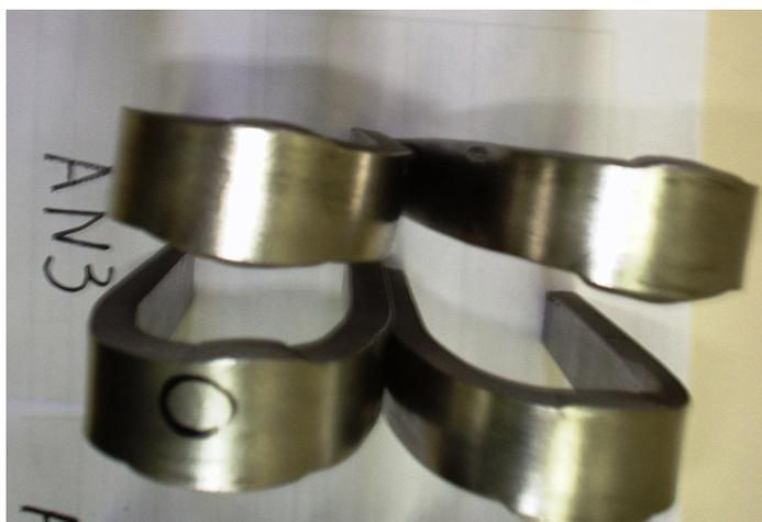
Figura 4.48 - Característica das superfícies, amostras AN3 após ensaio de dobramento.
