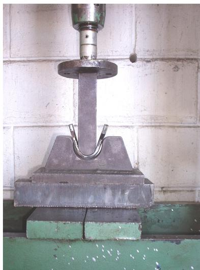
Figura 3.27 – Corpo-de-prova B4.2 (3) no final do ensaio de dobramento lateral da solda.
