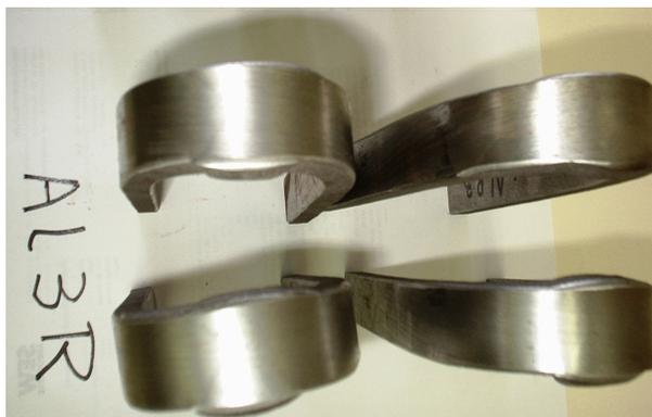
Figura 4.51 – Característica das superfícies, amostras AL3R após ensaio de dobramento.
