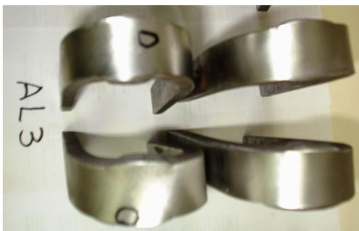
Figura 4.50 - Característica das superfícies, amostras AL3 após ensaio de dobramento.
