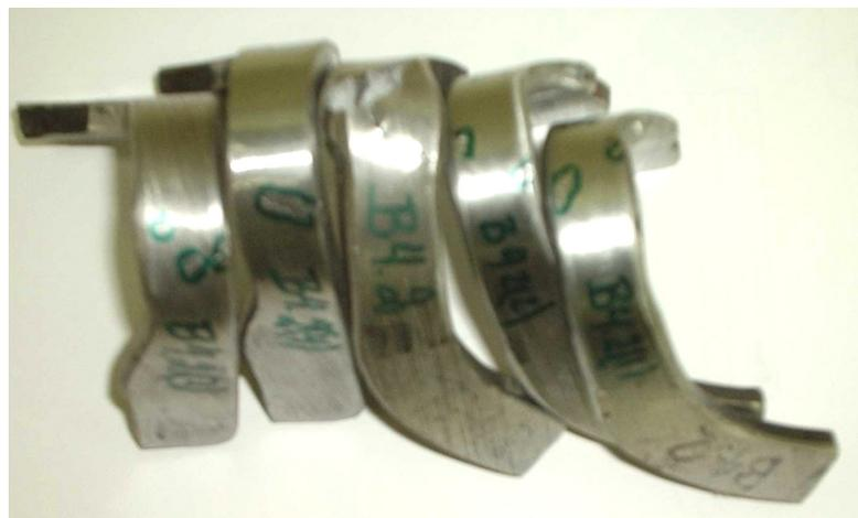
Figura 4.76 – Características superficiais após ensaio de dobramento lateral da solda para os CP'S B4.2.
