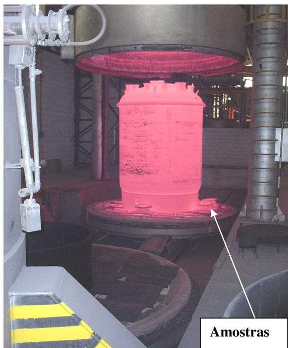
Figura 3.2 - Tratamento térmico das amostras junto com vaso de pressão em produção.
