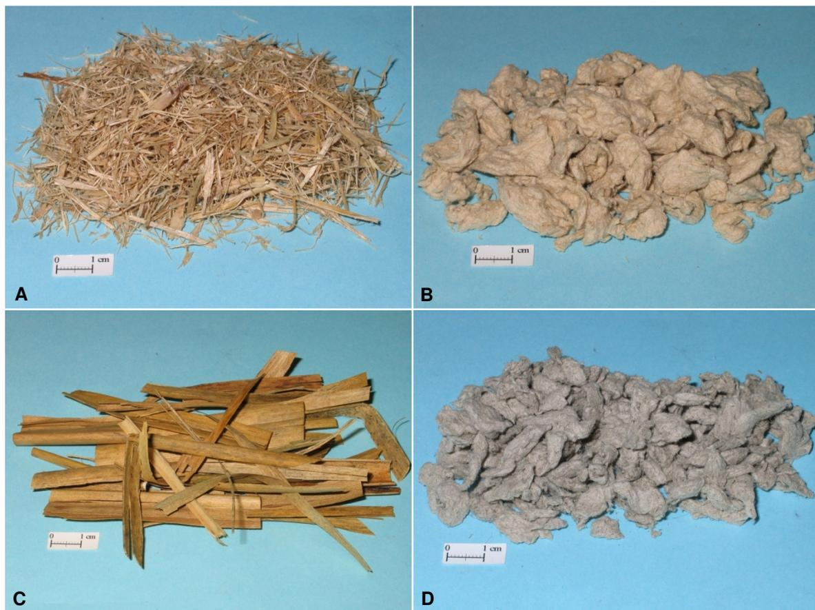
Figura 5.1. A e C) fibras *in natura* de bagaço e palha de cana, respectivamente; B e D) fibras celulósicas resultantes após polpação NaOH/AQ.
