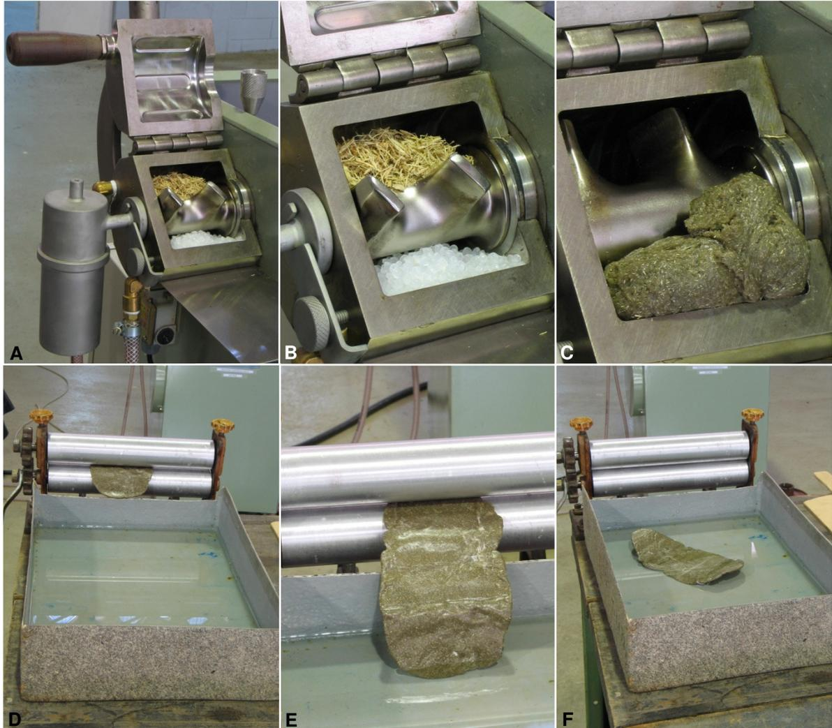
Figura 5.13. Esquema de preparação dos compósitos BNT utilizando o misturador termocinético. A-C) etapas de mistura e D-F) resfriamento.
