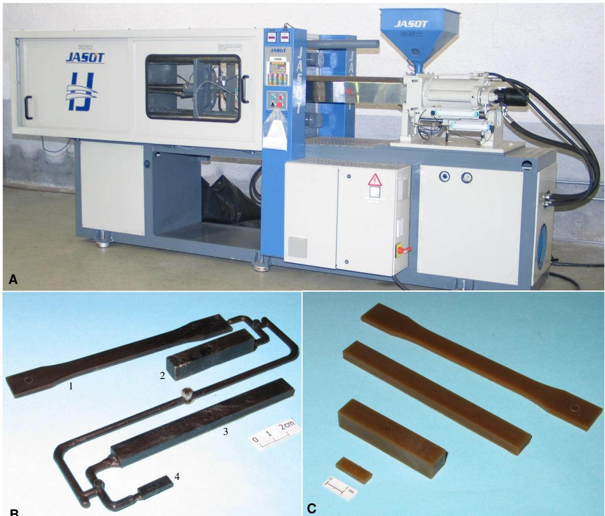
Figura 5.12. A) Máquina injetora; B e C) corpos de prova provenientes do molde instalado na injetora: 1 - tração, 2 - impacto, 3 - flexão e 4 - cisalhamento.
