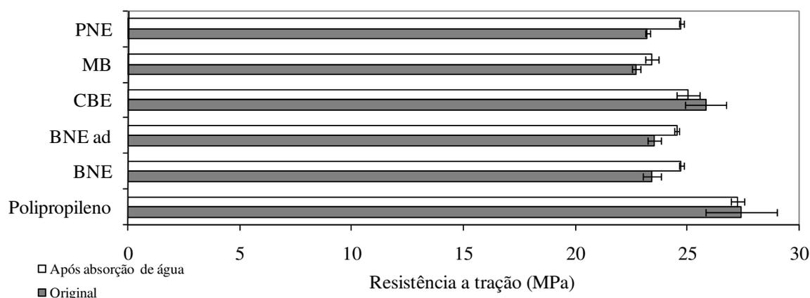
Figura 5.33. Resistência à tração dos compósitos de PP reforçados com diferentes fibras, ensaios realizados antes e após os testes de absorção de água.
