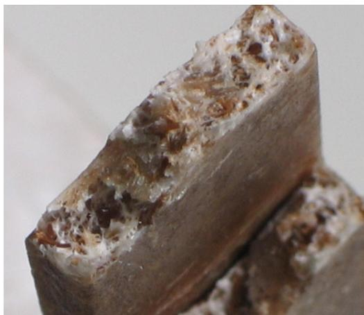
Figura 5.27. Corpo de prova de tração BNT 20% após fratura pelo ensaio mecânico.
