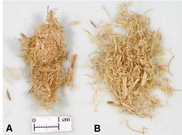
Figura 5.21. Comparação entre as fibras de bagaço não modificadas (branco) (A); e modificada por benzoilação (B).
