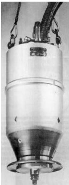
Figura 4 – Conjunto atomizador a disco centrífugo, com um disco atomizador na forma de um prato invertido, Foust *et al.* (1982)
