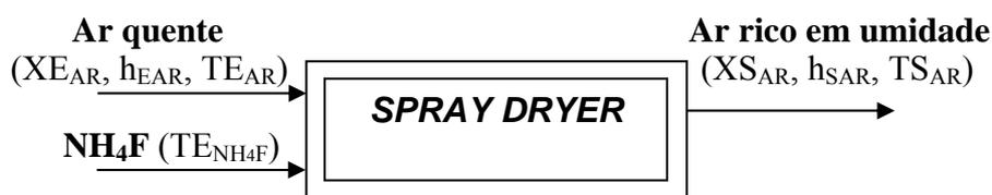
Figura 18 – Esquema do *spray dryer* para o balanço de energia, Blackadder e Nedderman (2004)
