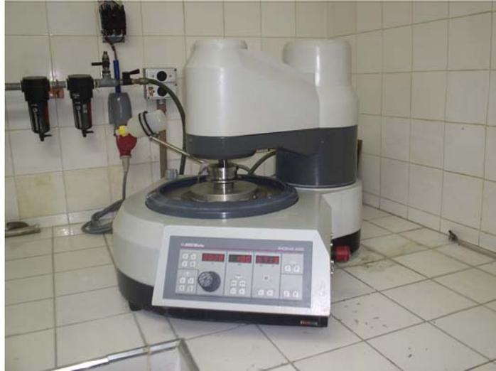
Figura 4.8 – Politriz automática utilizada na preparação das amostras.
