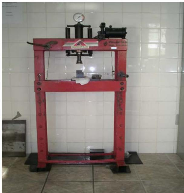
Figura 4.5. - Prensa uniaxial modelo Schulz utilizada na etapa de compactação.
