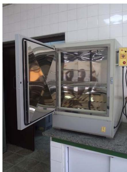
Figura 4.4 – Estufa utilizada na secagem das misturas de pós  $ZrO_2$ -Biovidro
