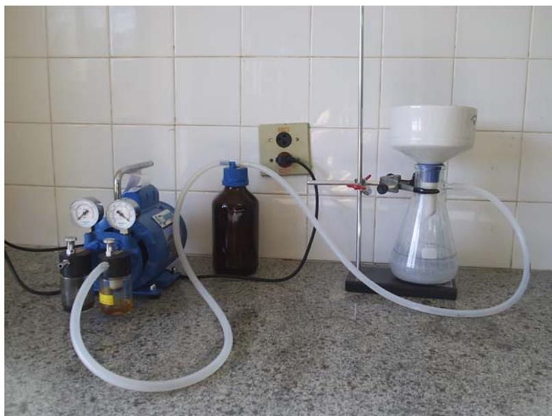
Figura 4.3 – Absorção à vácuo do líquido das misturas de pós
