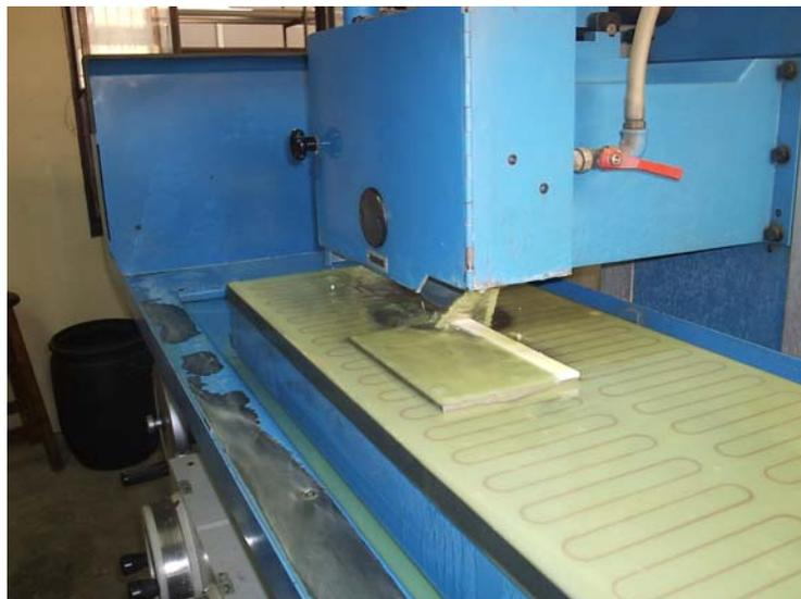
Figura 4.7 – Retífica automática utilizada para preparação superficial das amostras sinterizadas
