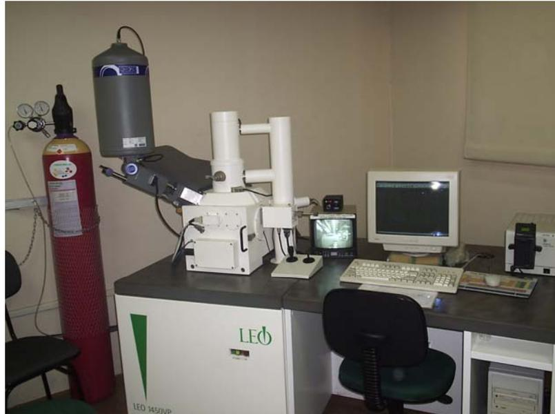
Figura 4.11.– Microscópio eletrônico de varredura – MEV
