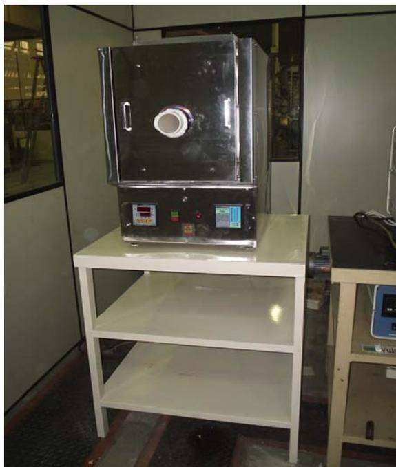
Figura 4.6. – Forno de sinterização FE1600 - INTI.
