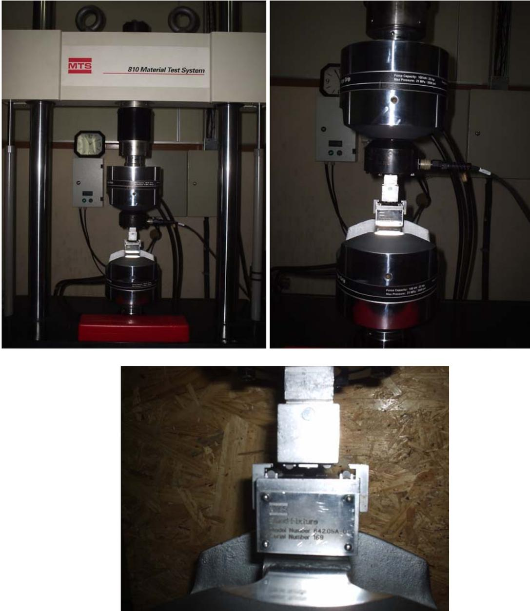
Figura 4.16 – Máquina Universal de Ensaios com adaptador para Flexão em 4 pontos
