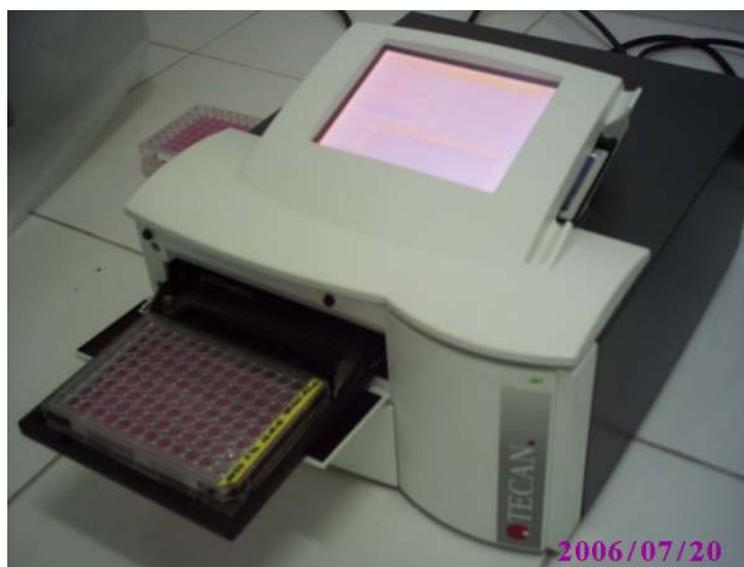
Figura A4 - Leitor de ELISA com filtro de 540nm e filtro de referência de 620nm.
