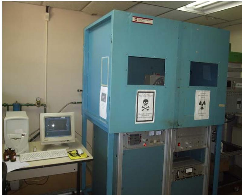
Figura 4.10 – Difratômetro de raios X utilizado nas análises de fase.
