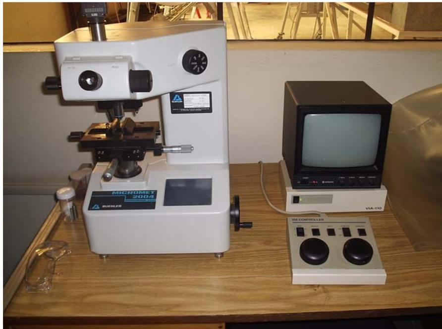
Figura 4.13 – Microdurômetro modelo MICROMET 2004..
