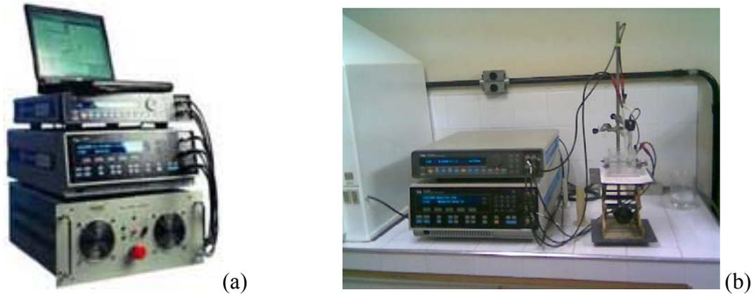
Figura 40 – (a) Potenciostato e Analisador de Resposta de Frequência (CA) on line com computador para registro de resultados (b) Equipamentos de espectroscopia de Impedância Eletroquímica do Laboratório de Corrosão do Departamento de Engenharia de Materiais da Escola de Engenharia de Lorena-USP.
