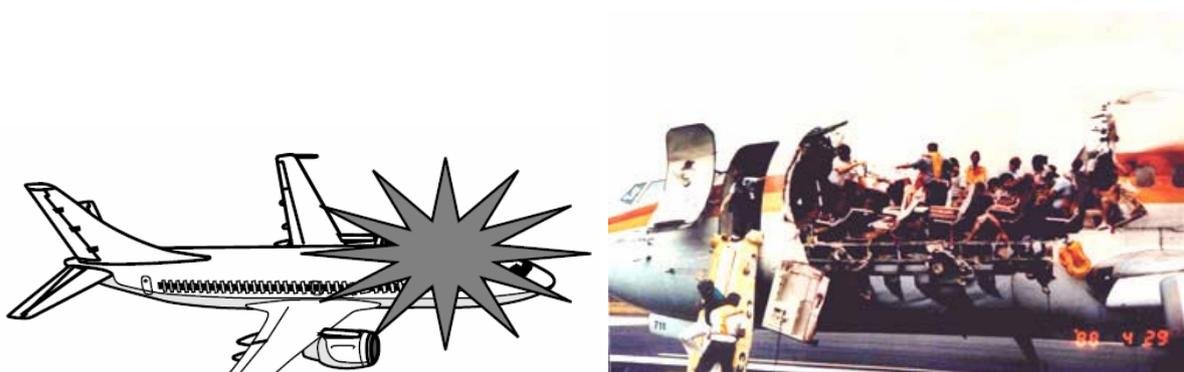
Figura 1 – Boeing 737-200 já no solo graças à bem sucedida aterrissagem da Aeronave após a explosiva descompressão que arrancou sua fuselagem superior em pleno vôo (11).
