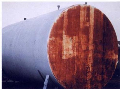
Figura 29 – Tanque de aço pintado com látex nas laterais e tinta acrílica a base d'água ao longo de sua extensão em um ensaio de corrosão atmosférica em campo. (25)
