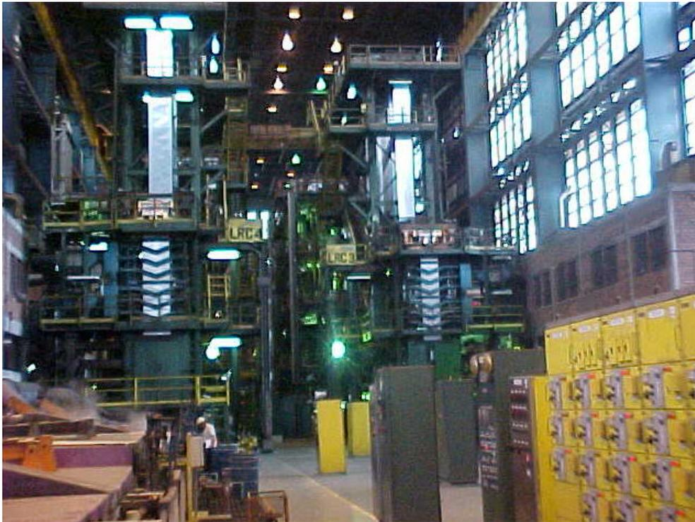
**Figura 1** – Ilustração mostrando uma das linhas de recozimento contínuo (LRC) da CSN.
