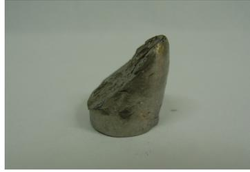
Figura 62 – Corpo-de-prova da liga Ti ensaiada em compressão, após a fratura.
