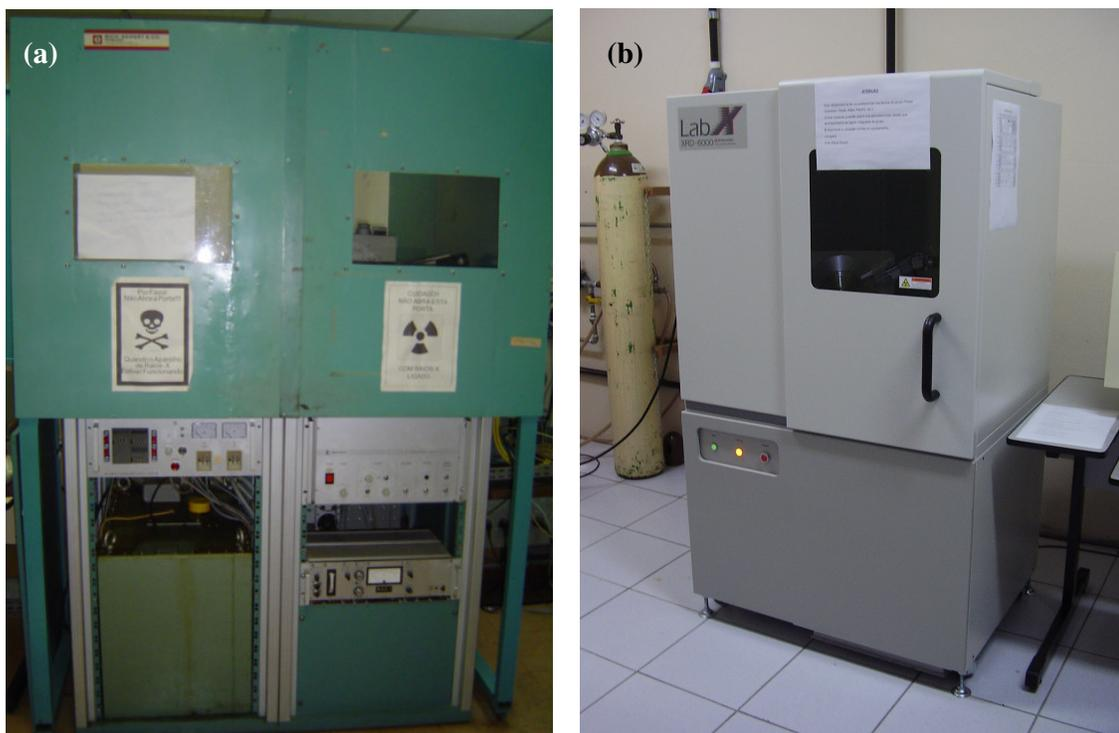
Figura 15 – a) Difratorômetro de raios X SEIFERT modelo ISODBYEFLEX 1001; b) Difratorômetro de raios X SHIMADZU modelo XRD-6000.
