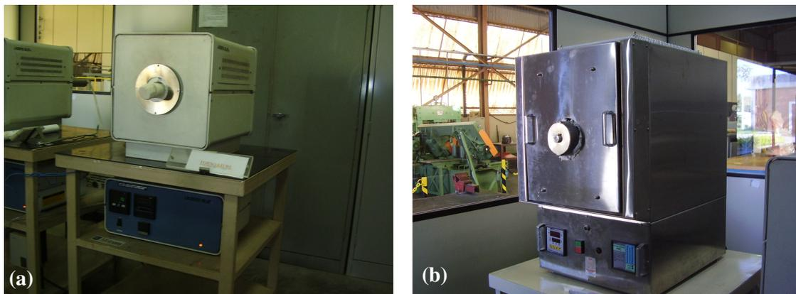
Figura 13 – a) Forno tubular LINDBERG/BLUE-M; b) Forno elétrico MAITEC-1650.
