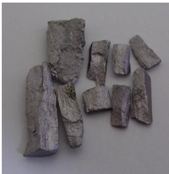
Figura 64 – Corpo-de-prova da liga 79Ti-14Si-7B ensaiada em compressão, após a fratura.
