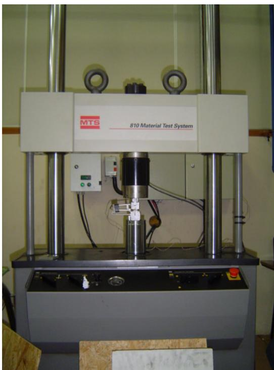
Figura 16 – MTS - Máquina universal de ensaios.
