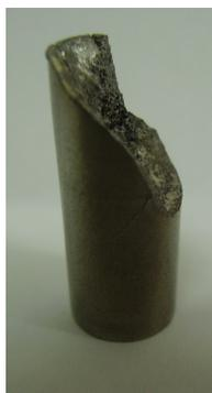
Figura 66 – Corpo-de-prova da liga 70Ti-20Si-10B ensaiada em compressão, após a fratura.
