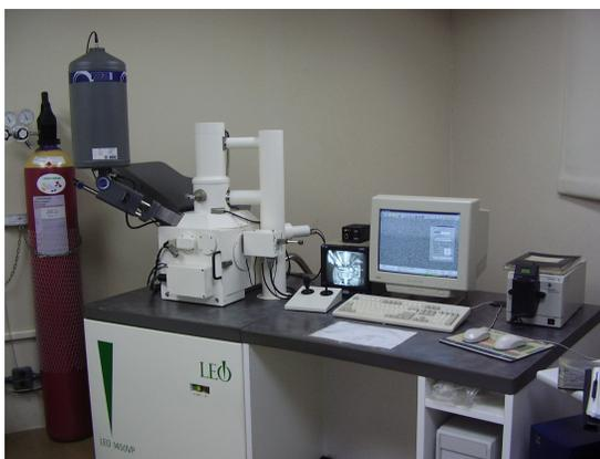
Figura 14 – Microscópio Eletrônico de Varredura LEO modelo 1450VP.
