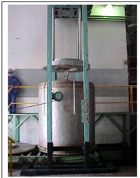
**Figura 2.6.** Vista parcial da prensa de compactação de línter <sup>4</sup>
