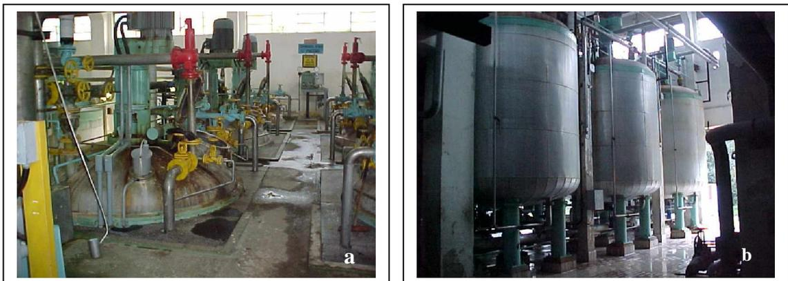
**Figuras 2.21.** a – Vista parcial da parte superior dos reatores de estabilização da nitrocelulose, sem pressão, b – vista lateral dos reatores de estabilização da nitrocelulose, em destaque três dos seis existentes<sup>12</sup>
