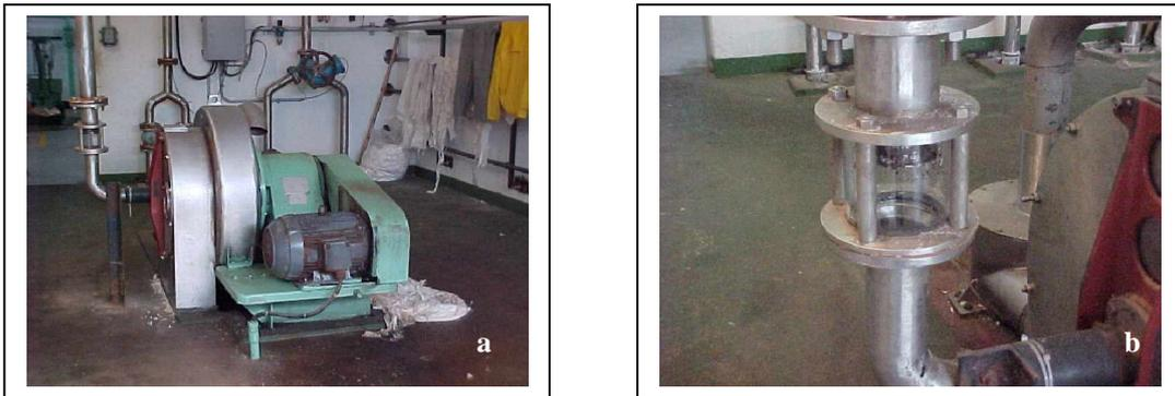
**Figuras 2.14.** a – Vista parcial da centrífuga que retira o excesso de água da celulose, b – detalhe do visor da centrífuga<sup>8</sup>
