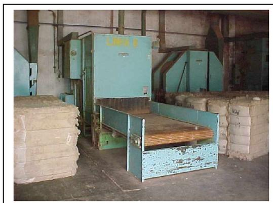
**Figura 2.4.** Vista parcial do desfibrador e fardos de línier<sup>2</sup>
