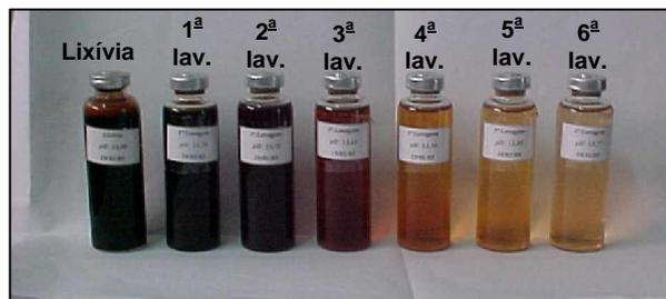
**Figura 5.1.** Cor dos efluentes da etapa de polpação alcalina do línter
