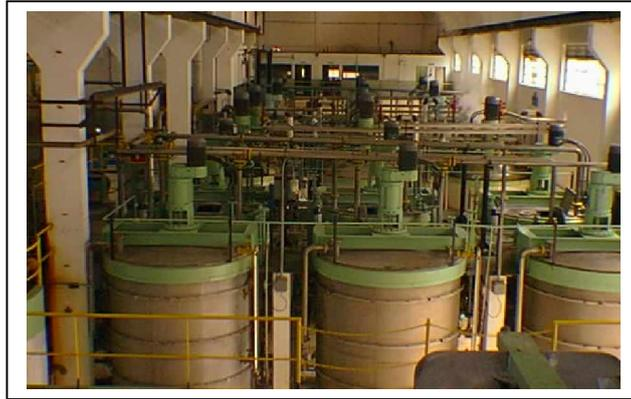
**Figura 2.20.** Vista parcial dos reatores de estabilização da nitrocelulose<sup>11</sup>
