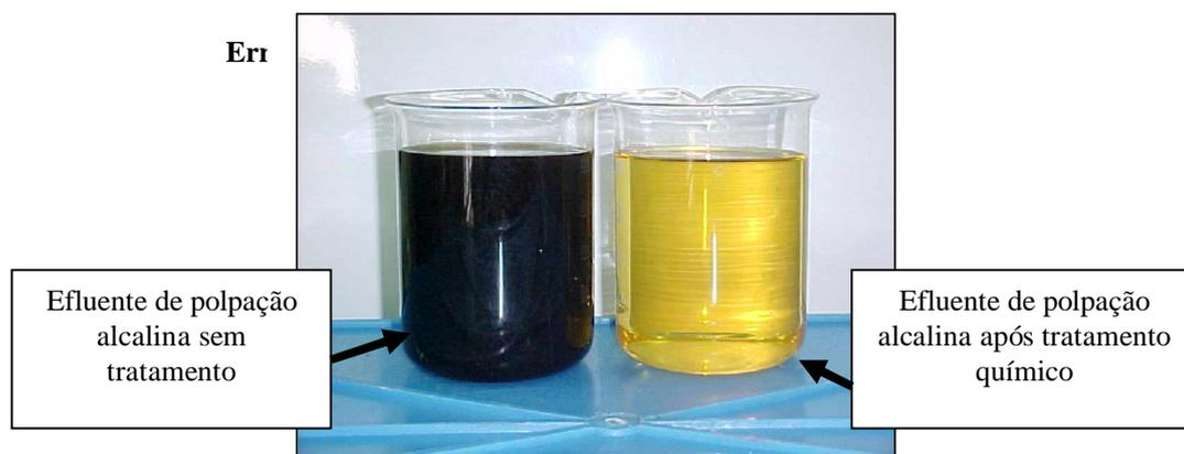
**Figura 5.3.** Efluente de polpação alcalina antes e após tratamento químico
