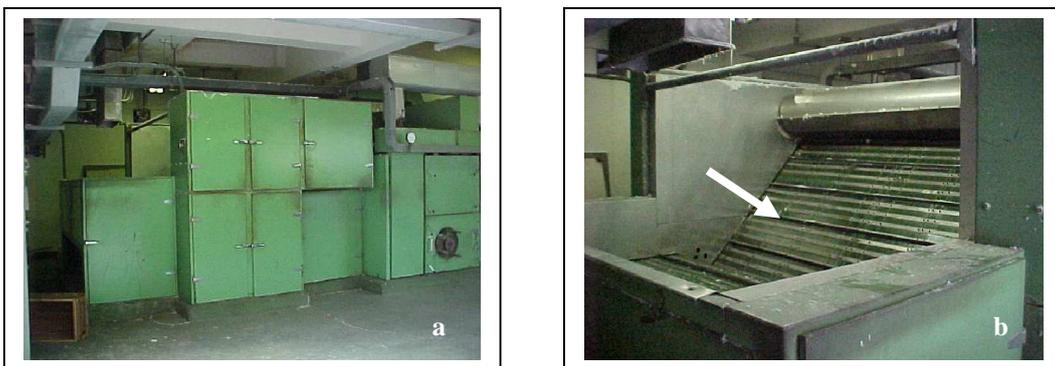
**Figuras 2.15.** a – Vista parcial do secador de celulose, b – vista parcial da esteira do secador<sup>9</sup>
