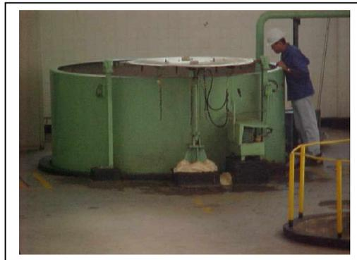
**Figura 2.12.** Vista parcial do tanque de dispersão da polpa celulósica<sup>6</sup>
