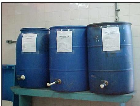
**Figura 4.2.** Esquema dos reatores utilizados no tratamento químico do efluente da etapa de polpação alcalina
