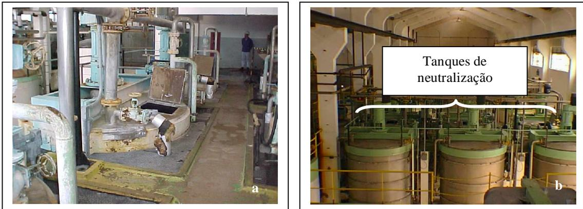
**Figuras 2.23.** a – Vista superior dos reatores de neutralização da nitrocelulose, b – vista lateral dos reatores de neutralização de nitrocelulose<sup>14</sup>
