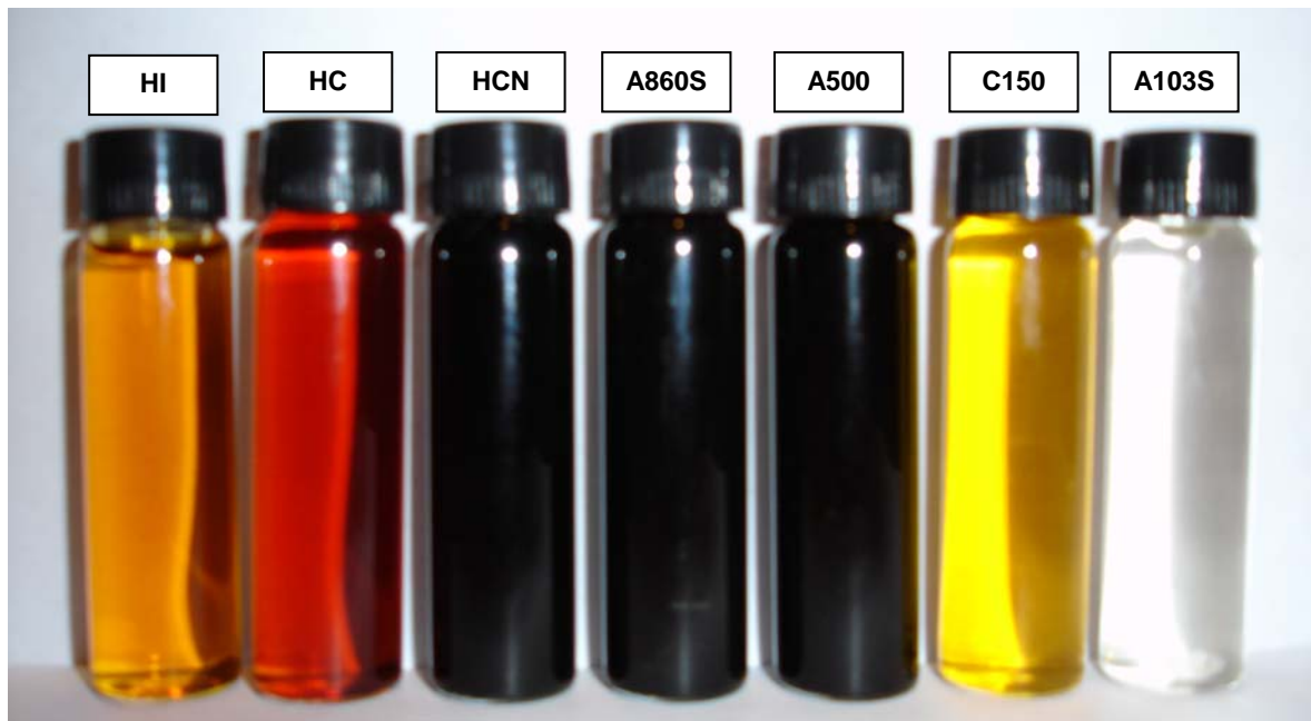
Figura 5.4 – Clarificação do hidrolisado em função das etapas de tratamento com resinas de troca iônica: inicial (HI), concentrado (HC), neutralizado (HCN) e tratado com as resinas A860S, A500, C150 e A103S.
