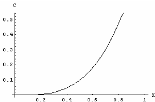
FIGURA 10 – Perfil de concentração em função da posição para cilindro infinito ( \alpha = 2 ) e ordem de reação n = 0,4 .
