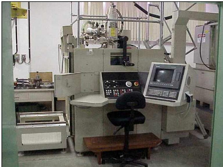
**Figura 2.18** – Máquina de solda por feixe de elétrons instalada nas dependências da INB (reprodução autorizada pela INB).
