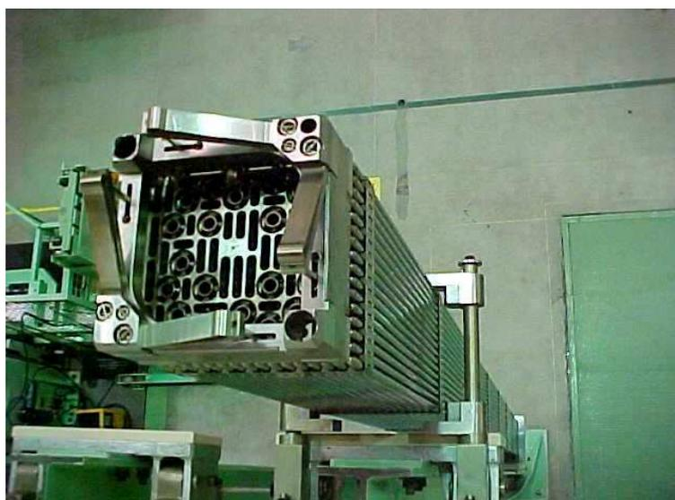
**Figura 2.6** – Vista geral do elemento combustível para reatores do tipo da usina de Angra 1 fabricado na INB (reprodução autorizada pela INB).
