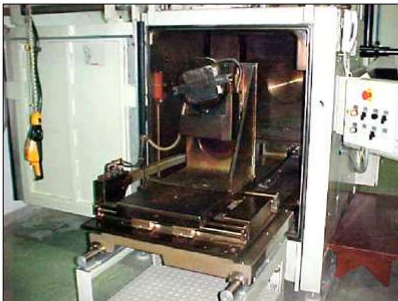
**Figura 3.6** – Detalhe da câmara da máquina de soldagem por feixe de elétrons instalada na INB, Resende – RJ (reprodução autorizada pela INB).
