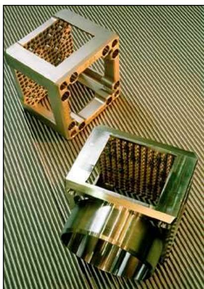
**Figura 2.10** – Vista dos bocais superior e inferior de Angra 2, fabricados na INB, no plano superior e inferior, respectivamente (reprodução autorizada pela INB).
