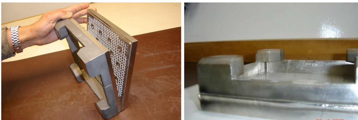
**Figura 3.9** – Seqüência de fabricação das soldas n° 4, 5 e 6: montagem da peça usinada AISI 304L com a peça fundida ACI CF-3 à esquerda; soldagem realizada à direita (reprodução autorizada pela INB).
