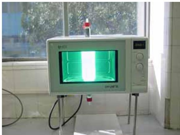
**Figura 12. Reator fotoquímico de recirculação ativado por microondas**
