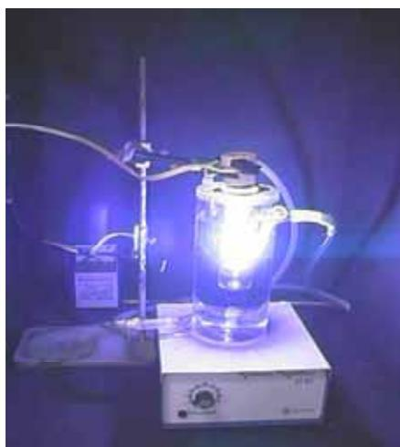
**Figura 11. Reator de irradiação interna**
