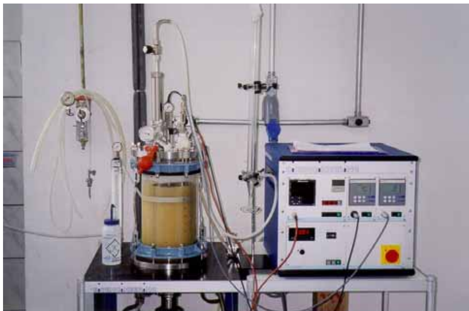
FIGURA 12. Fermentador usado para a obtenção de xilitol a partir da bioconversão de meio sintético e de hidrolisado hemicelulósico de bagaço de cana-de-açúcar por C. guilliermondii .
