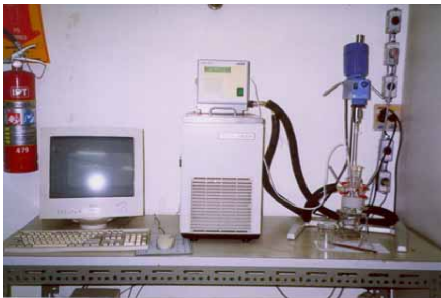
FIGURA 13. Sistema utilizado para realizar os estudos da cristalização de xilitol.
