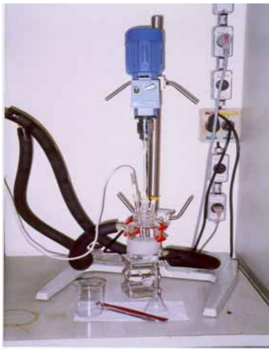
FIGURA 14. Sistema utilizado para realizar o estudo de solubilidade de xilitol comercial em água e em água-etanol.
