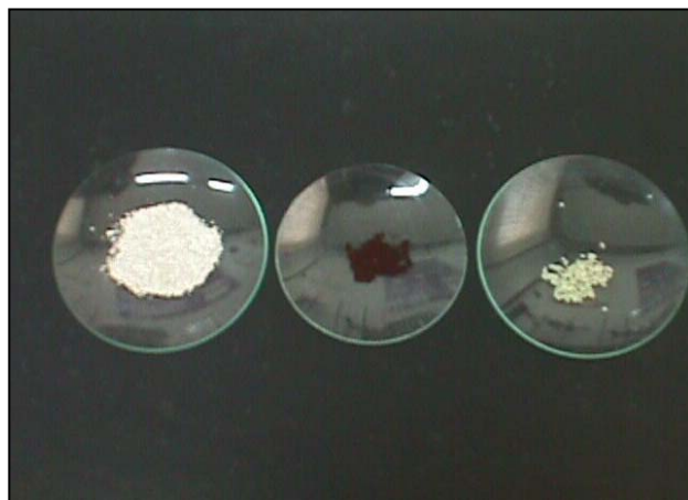
Figura 2.5: Produtos obtidos a partir dos negativos de raios-X: A) tiocianato de prata; B) cromato de prata; C) iodeto de prata;
