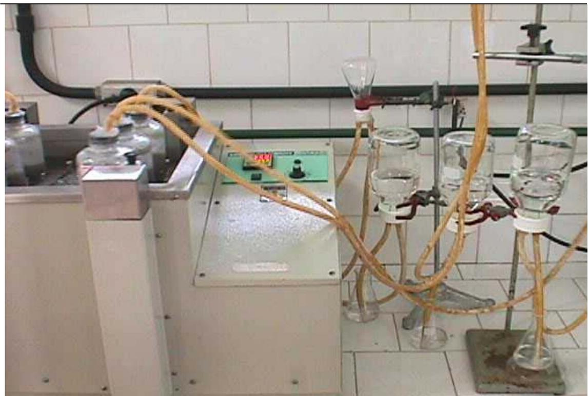
*Figura 4.15. Esquema representativo dos testes de biodegradabilidade anaeróbia (temperatura 35°C, agitação de 200 rpm).*
