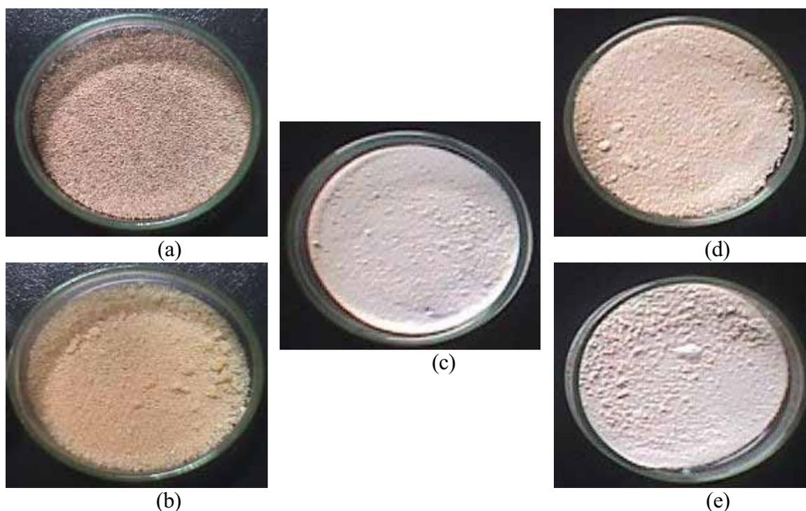
**Figura 3.1.** Ilustração dos sistemas imobilizados: (a) Lipozyme IM<sup>20</sup>; (b) Novozym 435; (c) LPP imobilizada em POS-PVA; (d) LCR imobilizada em POS-PVA; (e) LCR imobilizada em Nb<sub>2</sub>O<sub>5</sub>.
